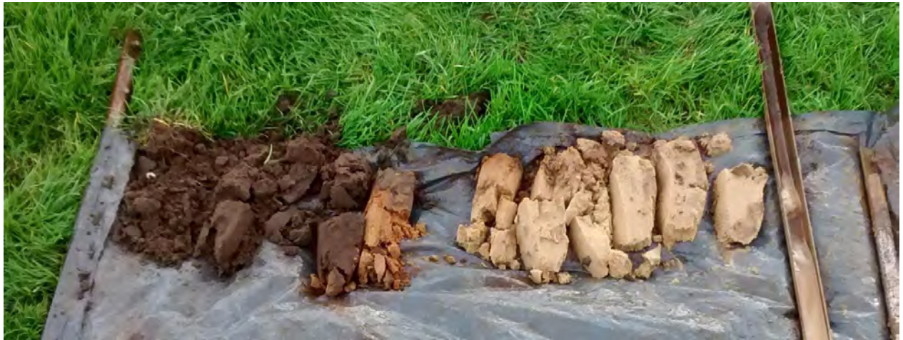
Afbeelding 12. Boring 5, boorkernen van 0-150cm.
