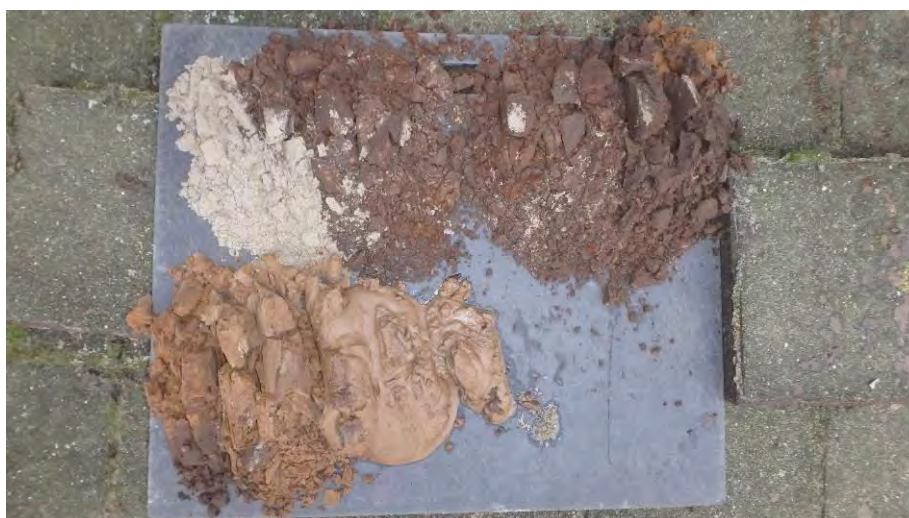
foto 3: bodemopbouw tot 200cm-mv van boring 101 (- richting)
