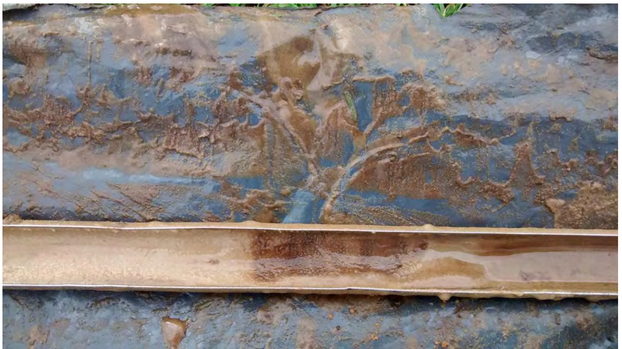
Afbeelding 12. Boring 2, detail paleosol (beneden huidige grondwaterpeil).
