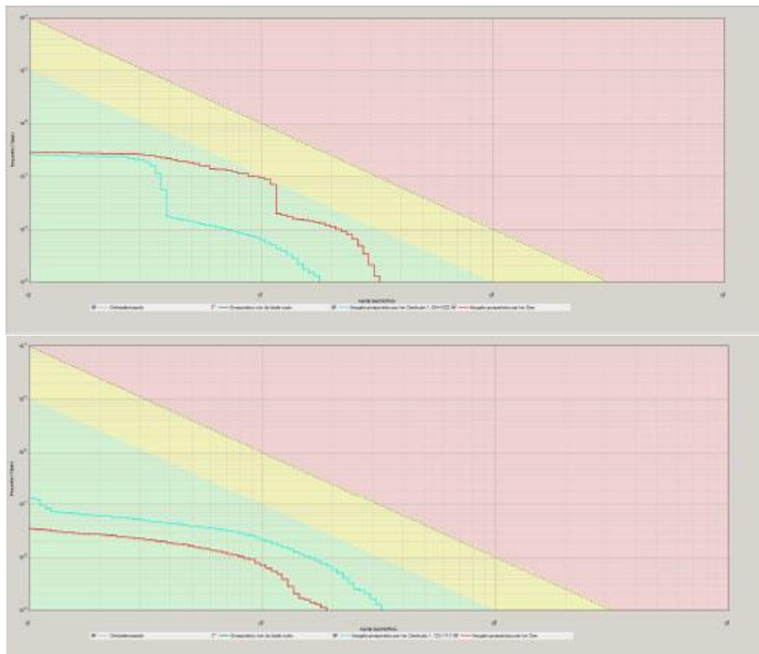
Afbeelding 11: FN-curves maatgevend kilometervak van N210 (boven) en A2 (onder).
