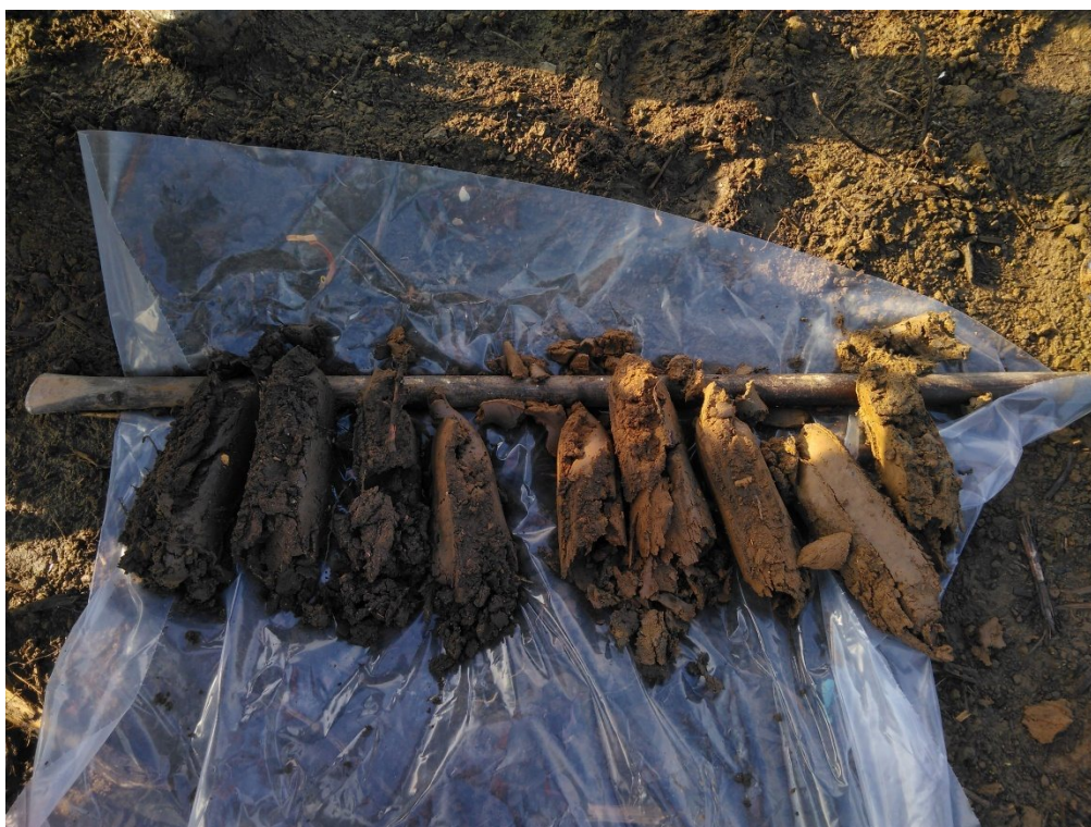
Foto 2: boorprofiel (bovenlaag = donkere (humeuze) kleigrond met daaronder lichtere siltige / zandige kleigrond)
