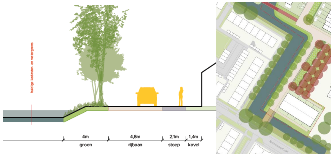
Figuur 5: Dwarsprofiel van de westelijke ontsluiting
