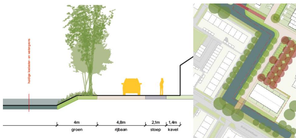
Dwarsprofiel van de westelijke ontsluiting
