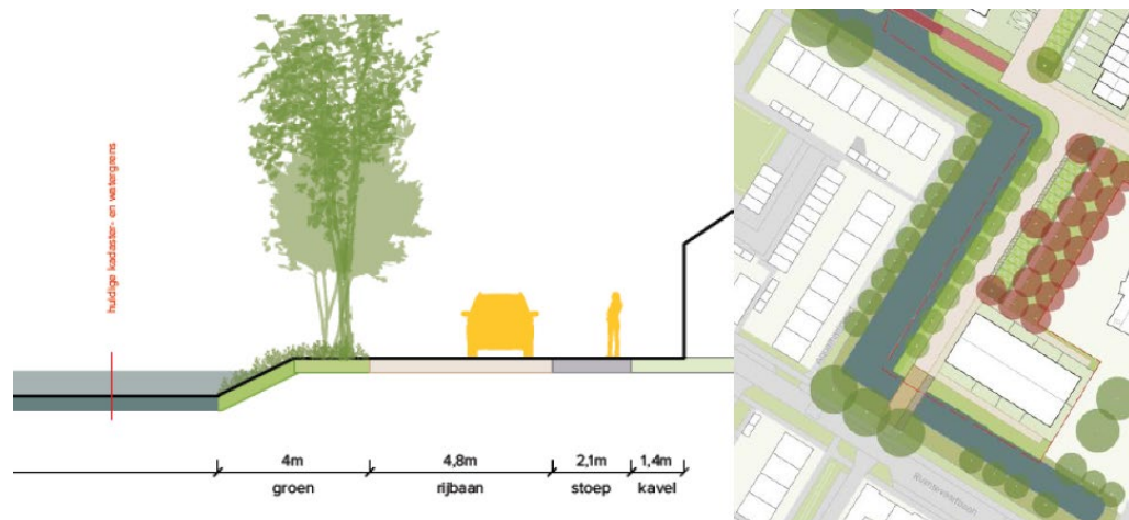
Dwarsprofiel van de westelijke ontsluiting
