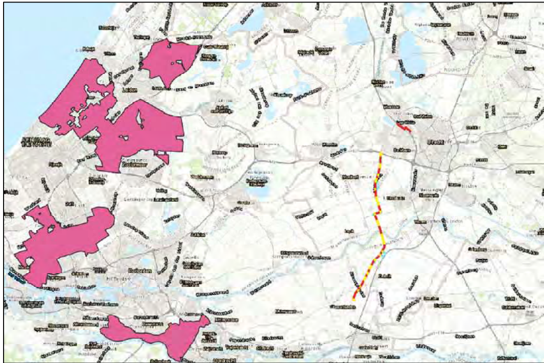
Figuur 4.54. Ligging van de tracés (rood = HDD, geel = open ontgravingen) en de werkstroken (blauw) ten opzichte van de groene buffer (roze) (bron achtergrond: Esri).
