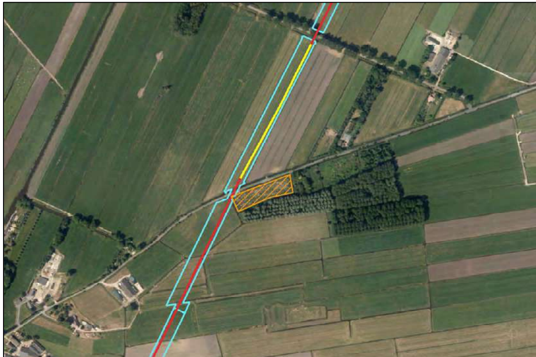
Figuur 5.5. Ligging van de tracés (rood = HDD, geel = open ontgravingen) en de werkstroken (blauw) ten opzichte van de mogelijke broedlocaties steenuil (oranje) (bron achtergrond: Esri).
