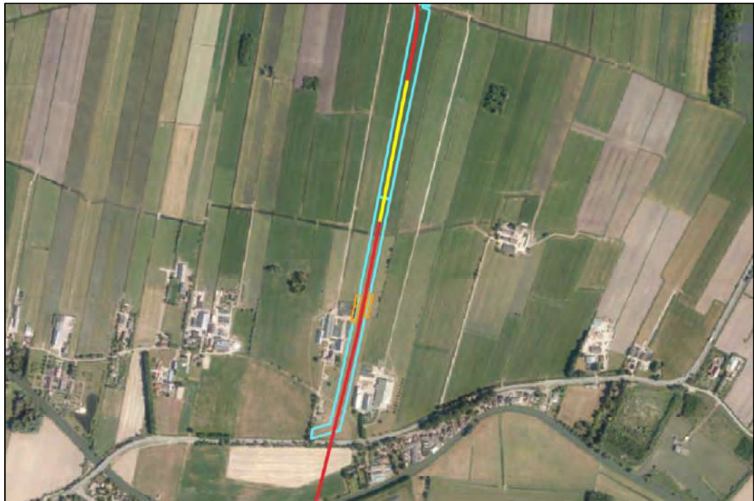
Figuur 5.1. Ligging van de tracés (rood = HDD, geel = open ontgravingen) en de werkstroken (blauw) ten opzichte van de mogelijke broedlocaties steenuil (oranje) (bron achtergrond: Esri).
