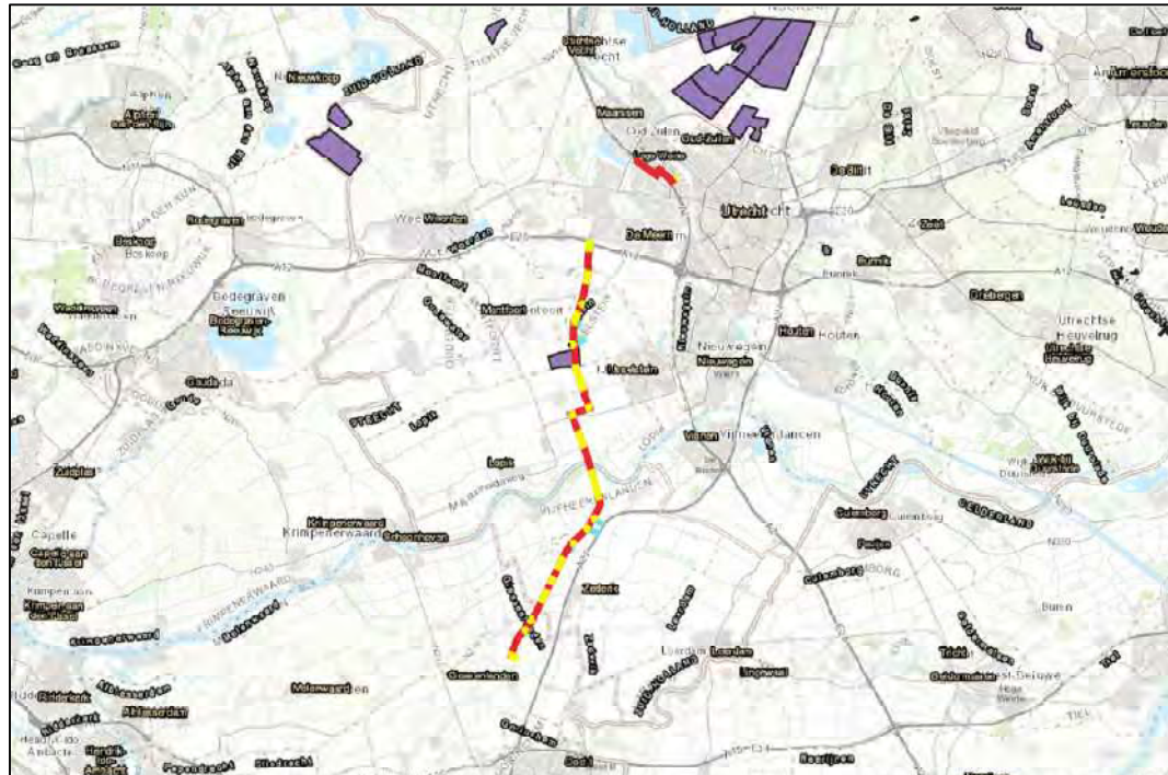
Figuur 4.49. Ligging van de tracés (rood = HDD, geel = open ontgravingen) en de werkstroken (blauw) ten opzichte van de waterparels (paars) (bron achtergrond: Esri).
