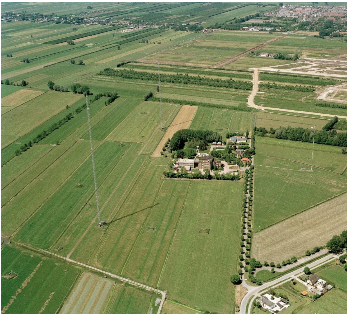
Luchtfoto van het zendercomplex en de omringende zendmasten door de Fotodienst van het Gemeentearchief Utrecht in 1996 (Het Utrechts Archief, beeldbank nr. X102730 - L7015-B). Links staan de masten uit 1939. Op de voorgrond staat de mast van 192 meter, daarachter de mast van 167 meter. Rechts staat de mast van 82 meter (1970).
