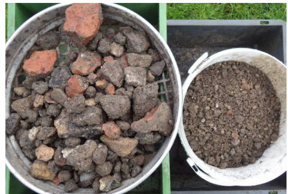
Foto 5: inspectiegat SL2 (gezeefd materiaal)
