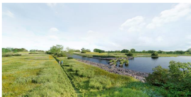
Figuur 5: Voorkeursvariant: impressie uiterwaard met boven de geulmonding (met schermenrij en oeverbescherming) en onder het zwemstrand en horecagelegenheid.
