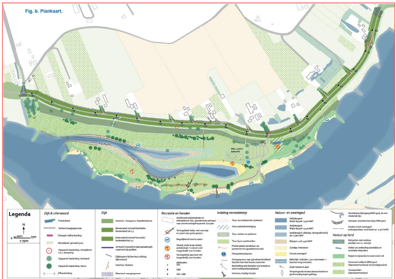
Figuur 6: Voorkeursvariant: impressie uiterwaard met boven de geulmonding (met schermenrij en oeverbescherming) en onder het zwemstrand en horecagelegenheid (VO+, WSP Nederland B.V., Strootman Landschapsarchitecten, RPS, ABT, 2021)
