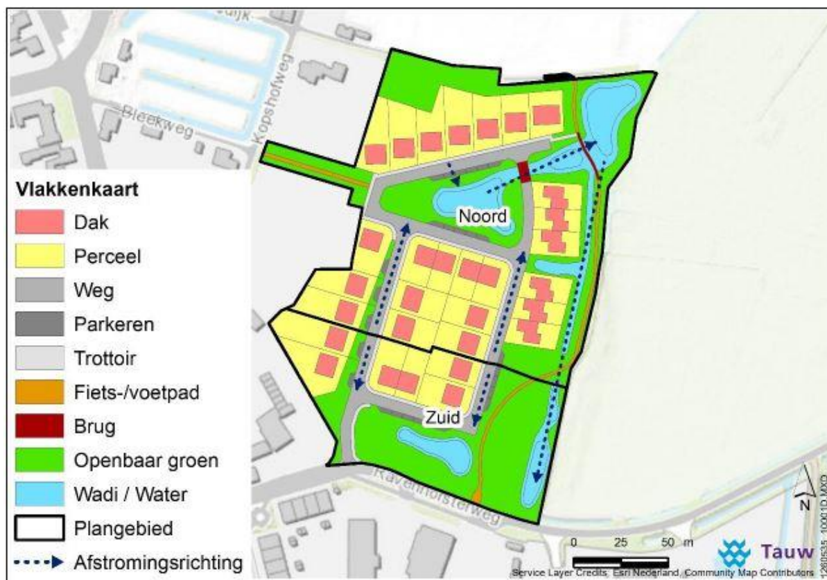
Afbeelding 5.7: Opvang hemelwater (bron: Tauw)
