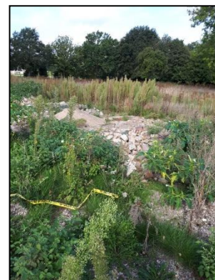
Figuur 8. Verscheidene hopen asbestverdacht bouwpuin.
