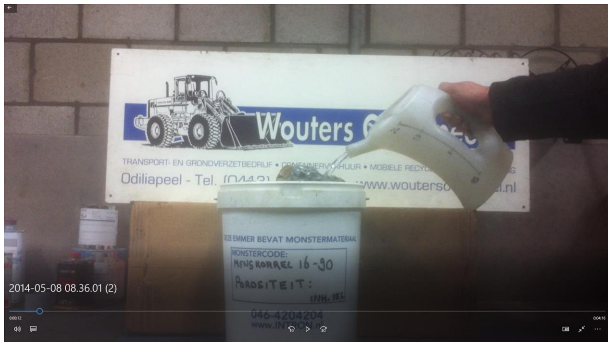
Figuur 1: Inhoud van emmer is 15 L, de emmer is gevuld met meng korrel 16-90, 1x 2 L water toegevoegd.
