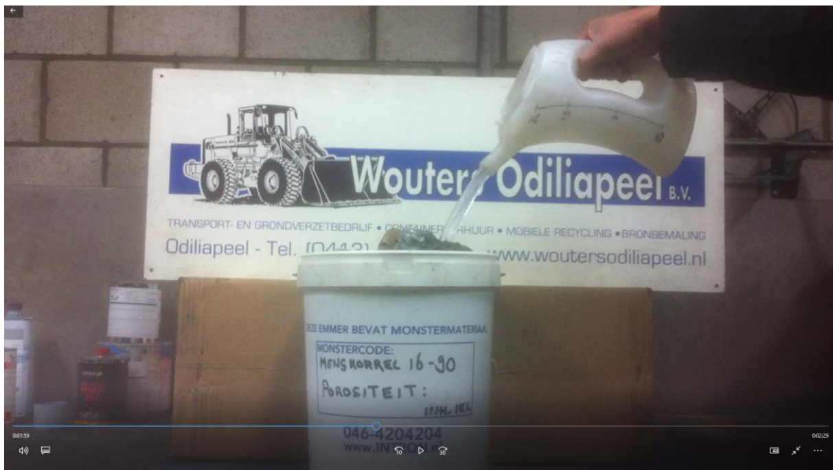
Figuur 3: 3x 2 L water toegevoegd, totaal 6 liter water in de emmer.
