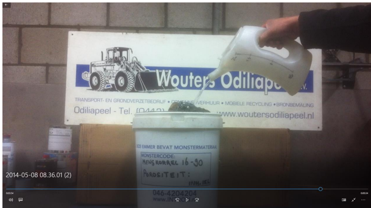
Figuur 5: 1x 1,5 L water toegevoegd, totaal 9,5 liter water in de emmer.
