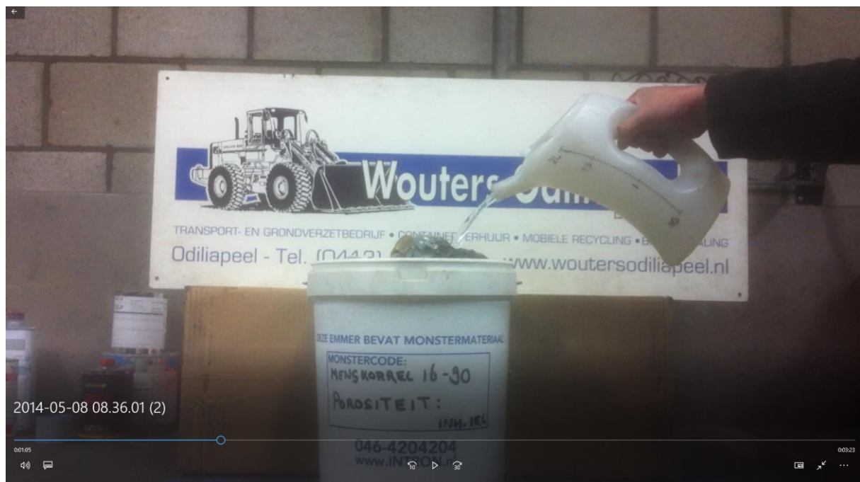
Figuur 2: 2x 2 L water toegevoegd, totaal 4 liter water in de emmer.
