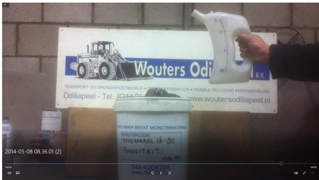
Figuur 6: Totaal 9,5 L in de emmer, het water staat tot de rand van de emmer. Totaal past er 9,5 liter water in een emmer van 15 liter gevuld met meng korrel 16-90.
