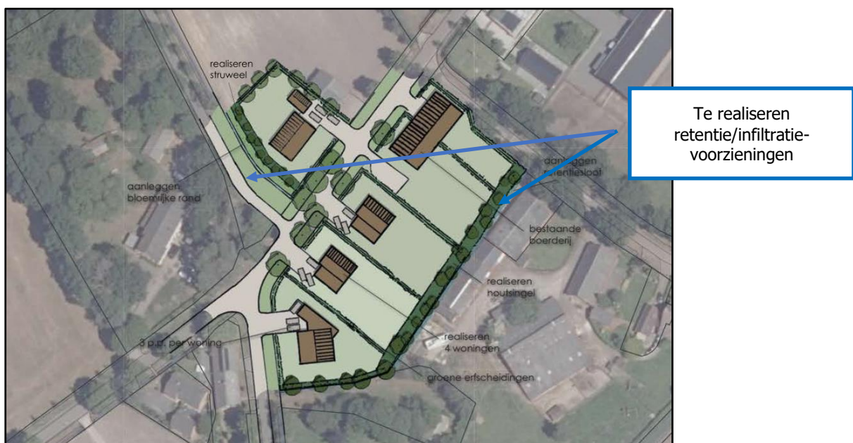
Afbeelding 21: weergave locatie te realiseren retentie/infiltratievoorzieningen
