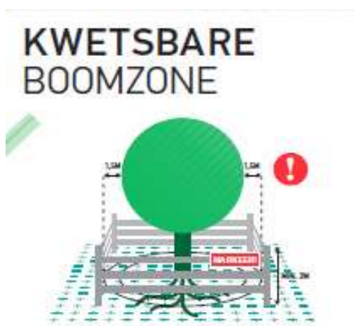
Afbeelding 2 Niet verplaatsbaar bouwhek plaatsen buiten de kroonprojectie
