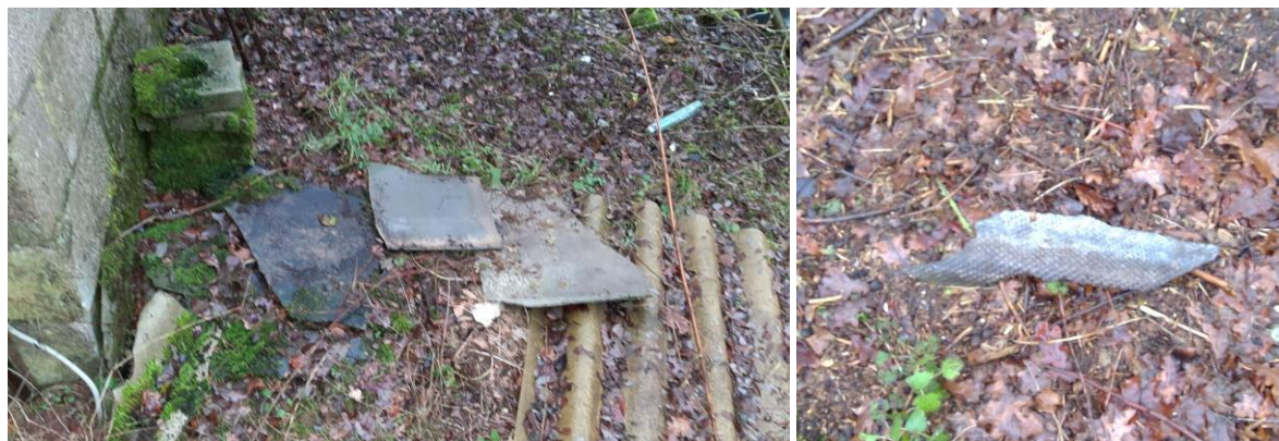
foto's: aangetroffen stukken asbest
