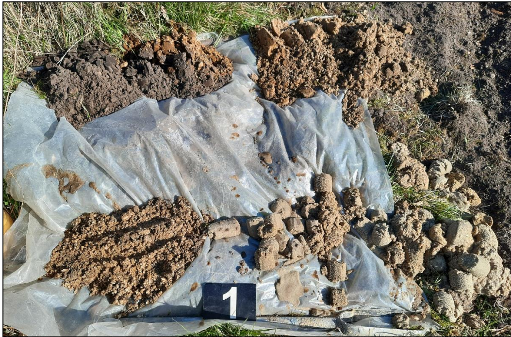
Afbeelding 2: Boorprofiel boring 1 vanaf maaiveld (linksboven) tot circa 1,9 meter onder maaiveld (rechtsonder).
