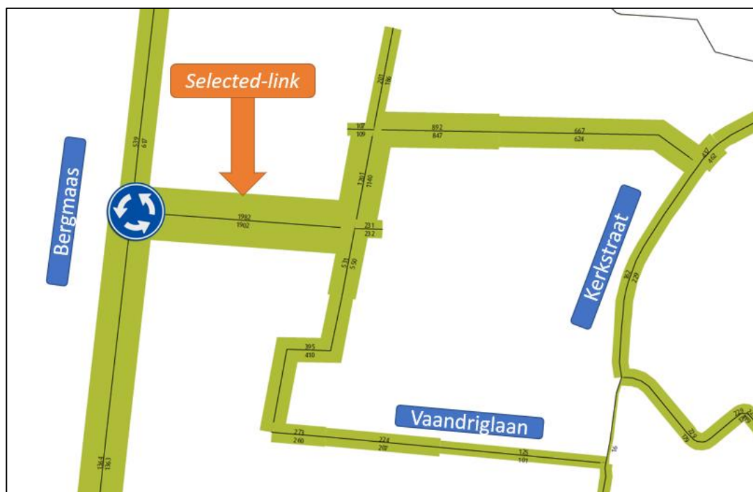
Figuur 3-2: Selected-link analyse ontsluitingsweg Repelakker III. Een selected-link analyse brengt in kaart wat de herkomst en bestemming is van het verkeer dat over een bepaalde weg rijdt.
