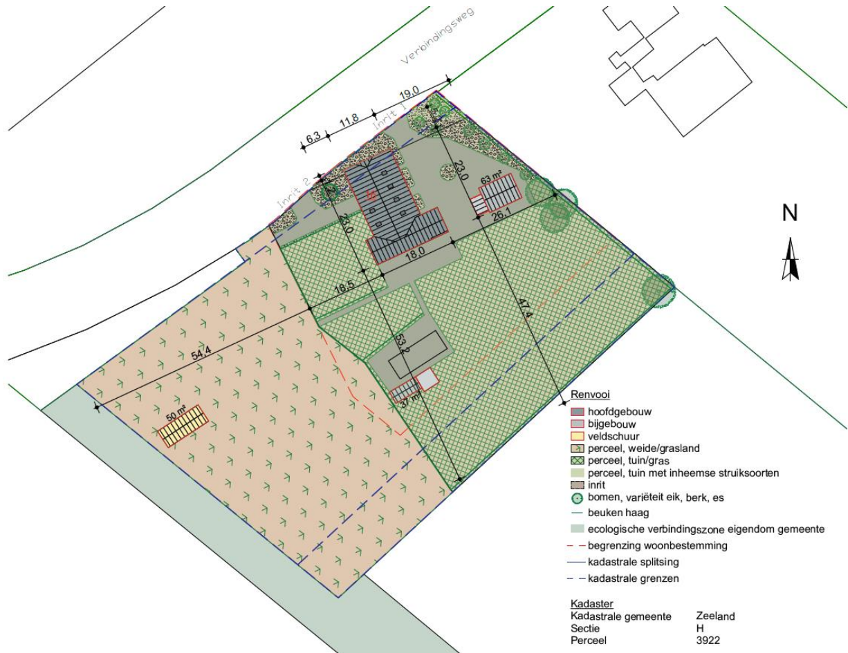
Figuur 4 bestaande situatietekening
