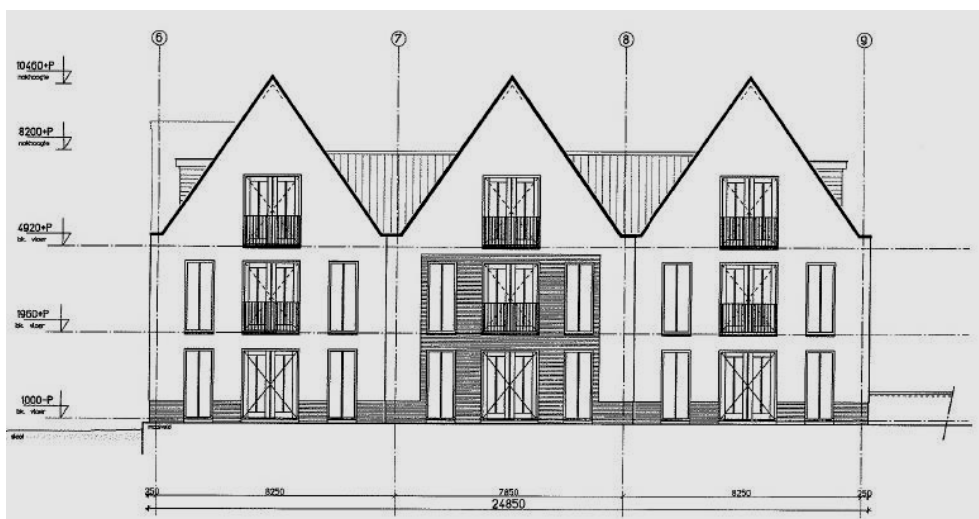
Figuur 17. Gevelbeeld vanaf verbindingsbrug (bron: ME2 architecten)
