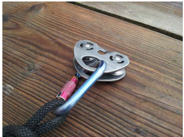
Afbeelding 6.3: geleider tokkelbaan kogellager gelagerd
