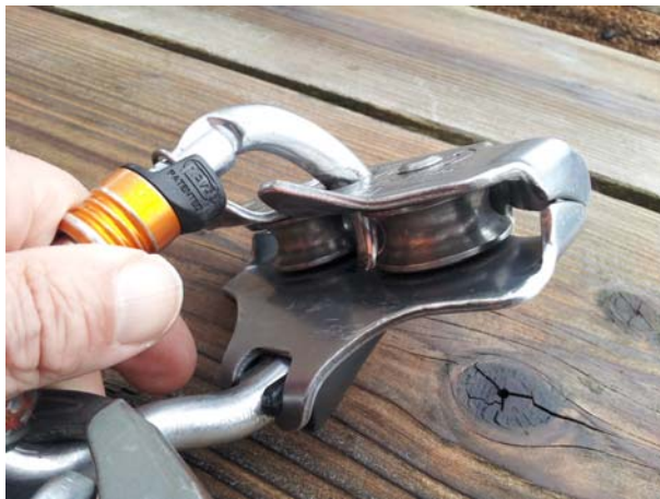
Afbeelding 6.2: geleider tokkelbaan asgelagerd
