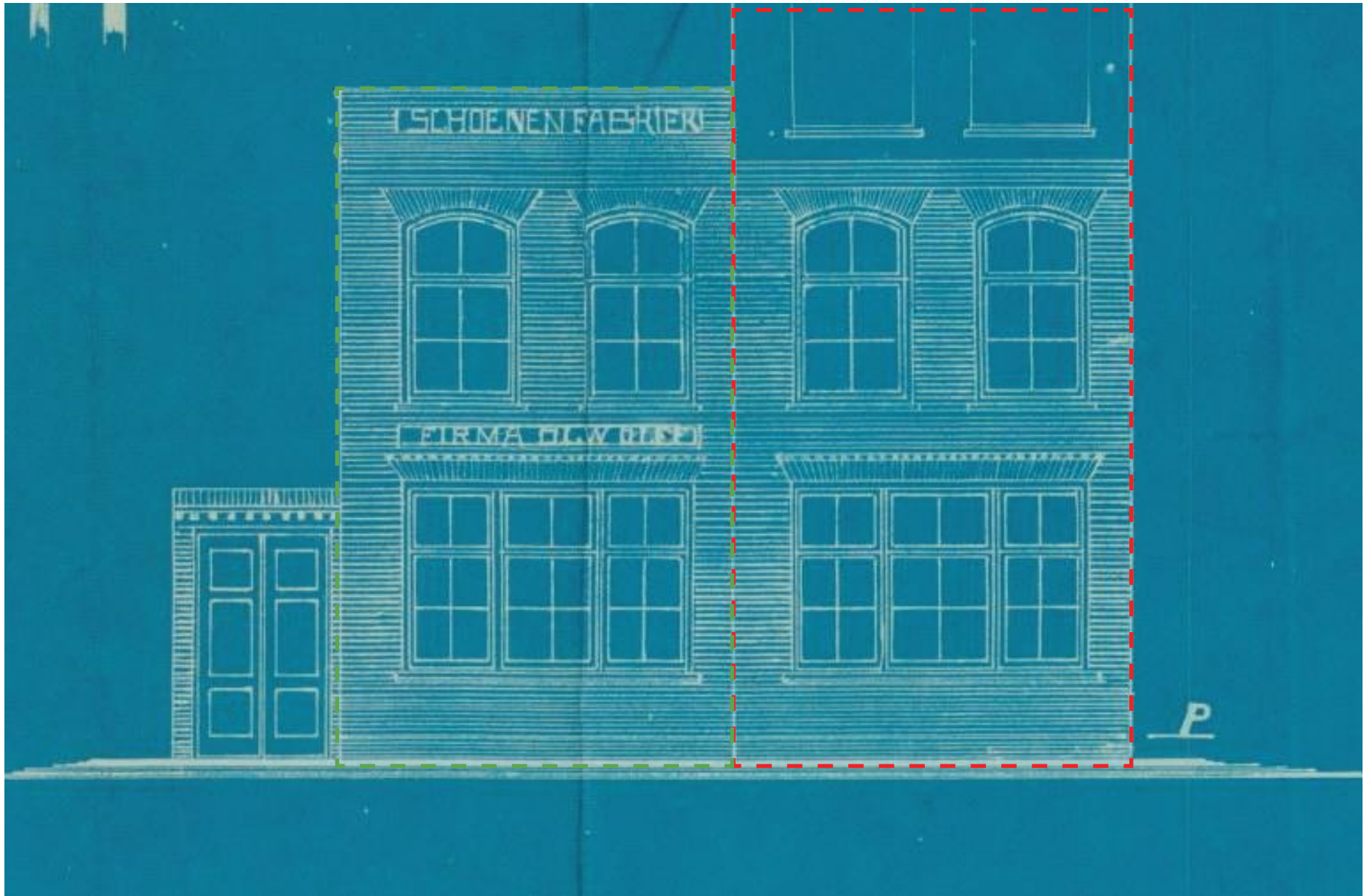
Afb. 16 Toestand van de gevel van het voormalige perceel A 119 (groen omkaderd) en de eerste twee bouwlagen van het linker deel van het voormalige woonhuis (rood omkaderd) met helemaal links de poort voor de steeg naar het achterterrein.
