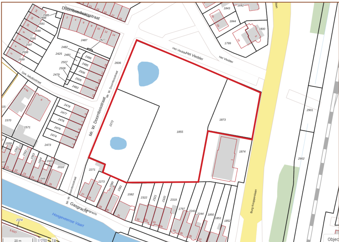
Afb. 1.2: Kadastrale situatie plangebied. Op deze kaart zijn ook enkele ondiepe poelen te zien die ontstaan zijn door het uitgraven van de kelders van het voormalige schoolgebouw. Bron: pdok.nl/viewer.
