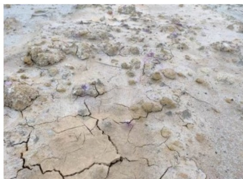
Afbeelding 2: Zintuiglijke verkleuringen toplaag onderzoekslocatie / monsternamepunt – Achthoven-Oost 13 te Montfoort
