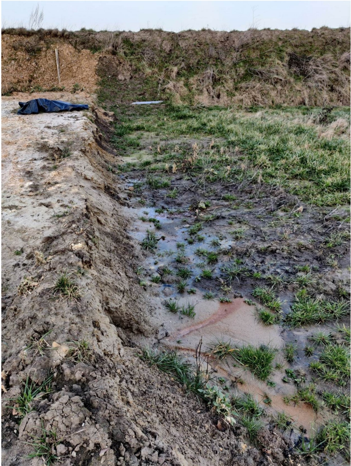
Foto 3: zintuiglijke verkleuringen rond uitloop van 'water' uit opgebrachte zandlaag naar naastgelegen akker (olieachtige filmlaag)
