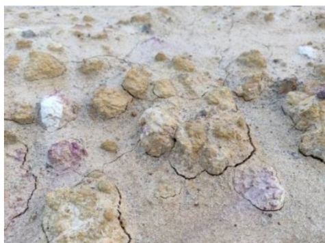
Afbeelding 2: Zintuiglijke verkleuringen toplaag onderzoekslocatie / monsternamepunt – Achthoven-Oost 13 te Montfoort
