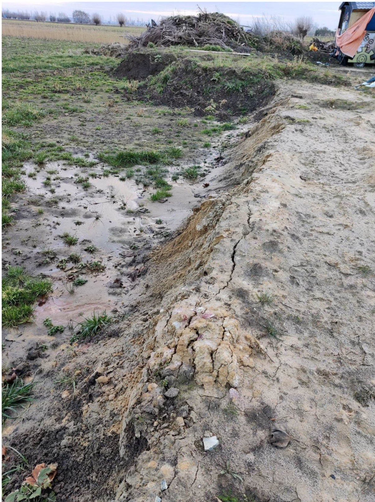
Foto 4: zintuiglijke verkleuringen rond uitloop van 'water' uit opgebrachte zandlaag naar naastgelegen akker (olieachtige filmlaag)
