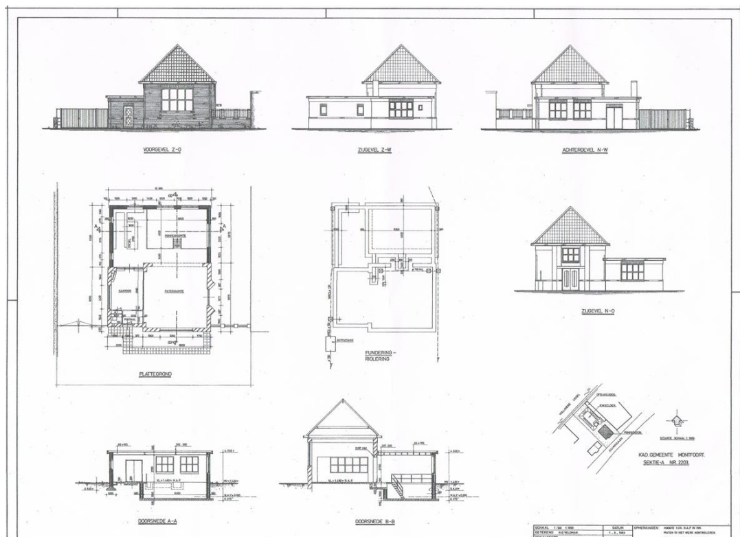
Figuur 2.3: Bestaande situatie pompgebouw
