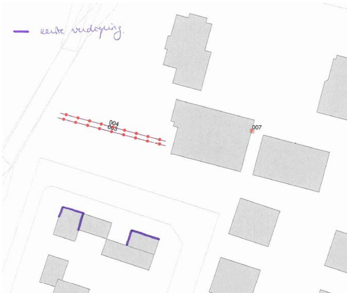
Figuur 8.3 Gevels waarop geluidvoorschriften door huidige bedrijfsvoering Artifice worden overschreden
