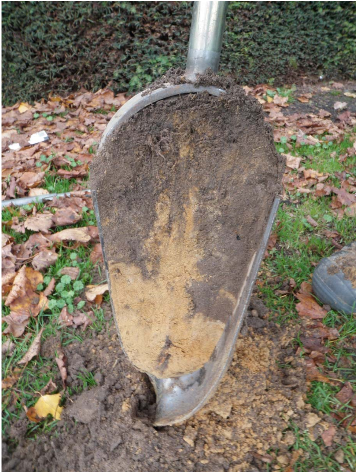
Figuur 15: Detailfoto van boring 3 met daarop de duidelijke overgang tussen de bouwvoor en de onderliggende C-horizont.
