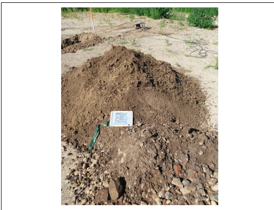
Foto 13. Opgegraven, gezeefd materiaal asbestinspectiesleuf 2.3
