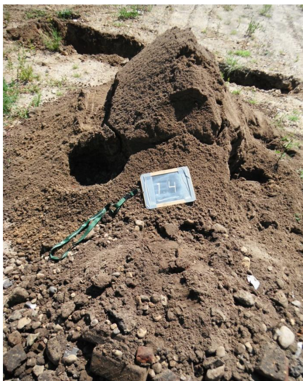
Foto 7. Opgegraven, gezeefd materiaal asbestinspectiesleuf 1.4
