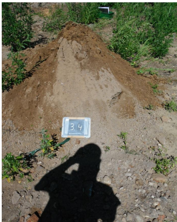
Foto 18. Opgegraven, gezeefd materiaal asbestinspectiesleuf 3.4
