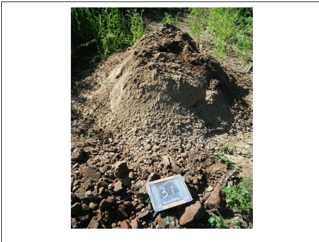
Foto 15. Opgegraven, gezeefd materiaal asbestinspectiesleuf 3.1
