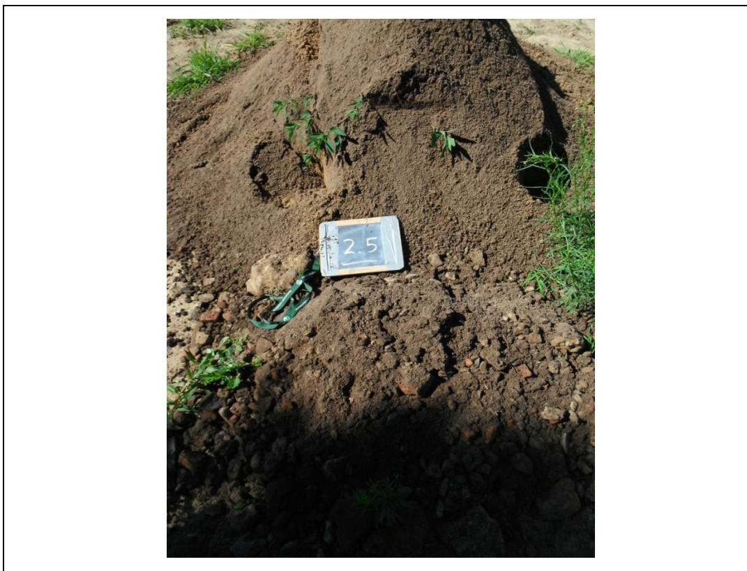
Foto 15. Opgegraven, gezeefd materiaal asbestinspectiesleuf 2.5
