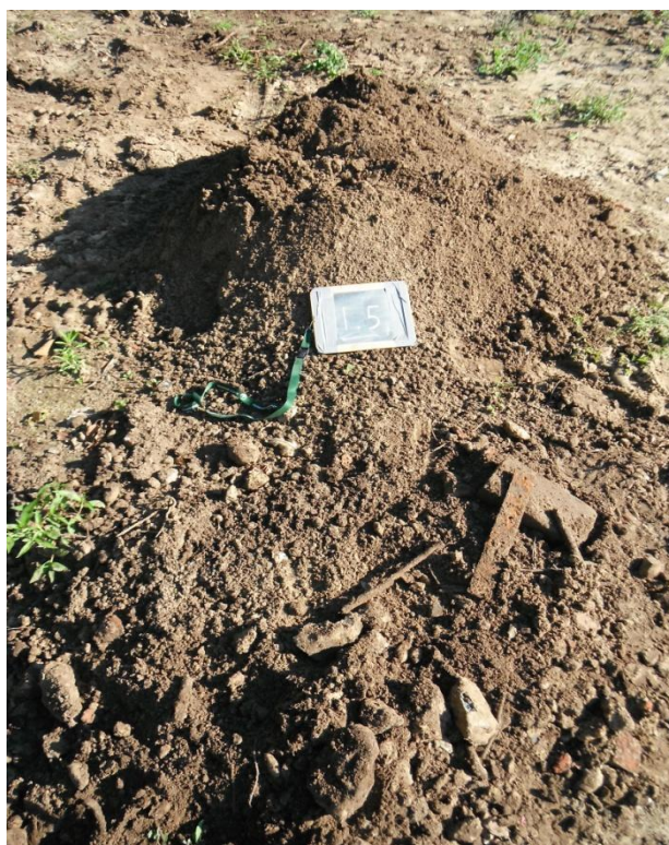
Foto 9. Opgegraven, gezeefd materiaal asbestinspectiesleuf 1.5
