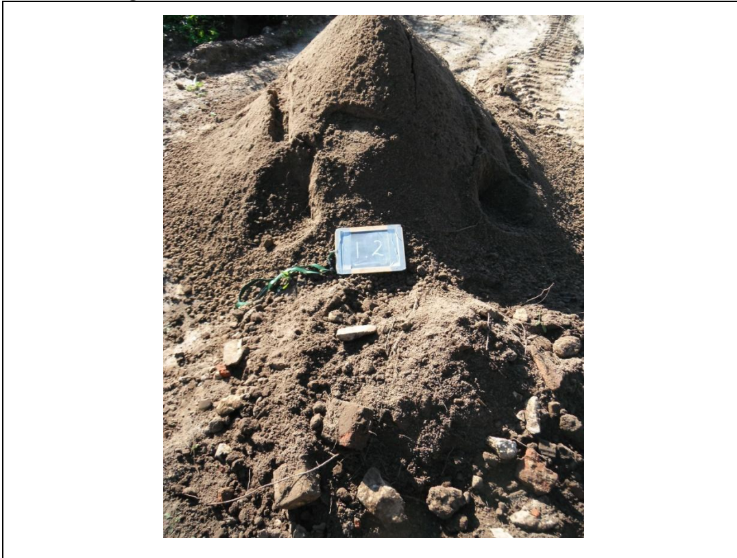
Foto 3. Opgegraven, gezeefd materiaal asbestinspectiesleuf 1.2
