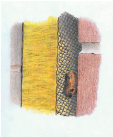
Figuur 7. Vleermuis hangt aan griplaag op isolatiemateriaal
