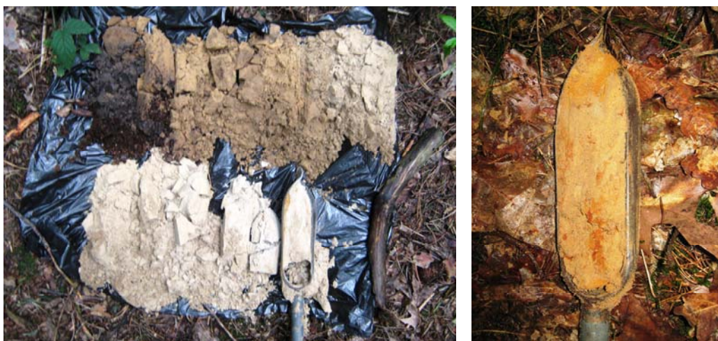
Figuur 3 Aangetroffen bodemprofiel en detailopname roest in bodem
