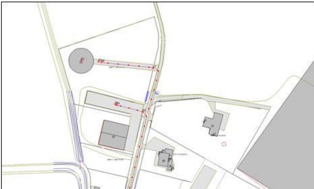
Afbeelding 19. Nieuwe inrit mestsilo (uit akoestisch oogpunt een verbetering voor omliggende woningen)
