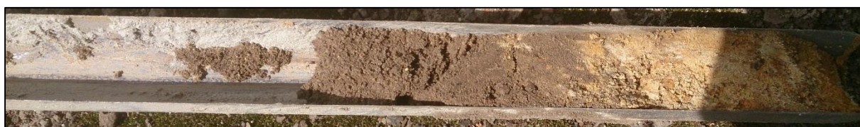
Figuur 5: Detail van de overgang naar de ondergrond in het profiel van boring 3b
