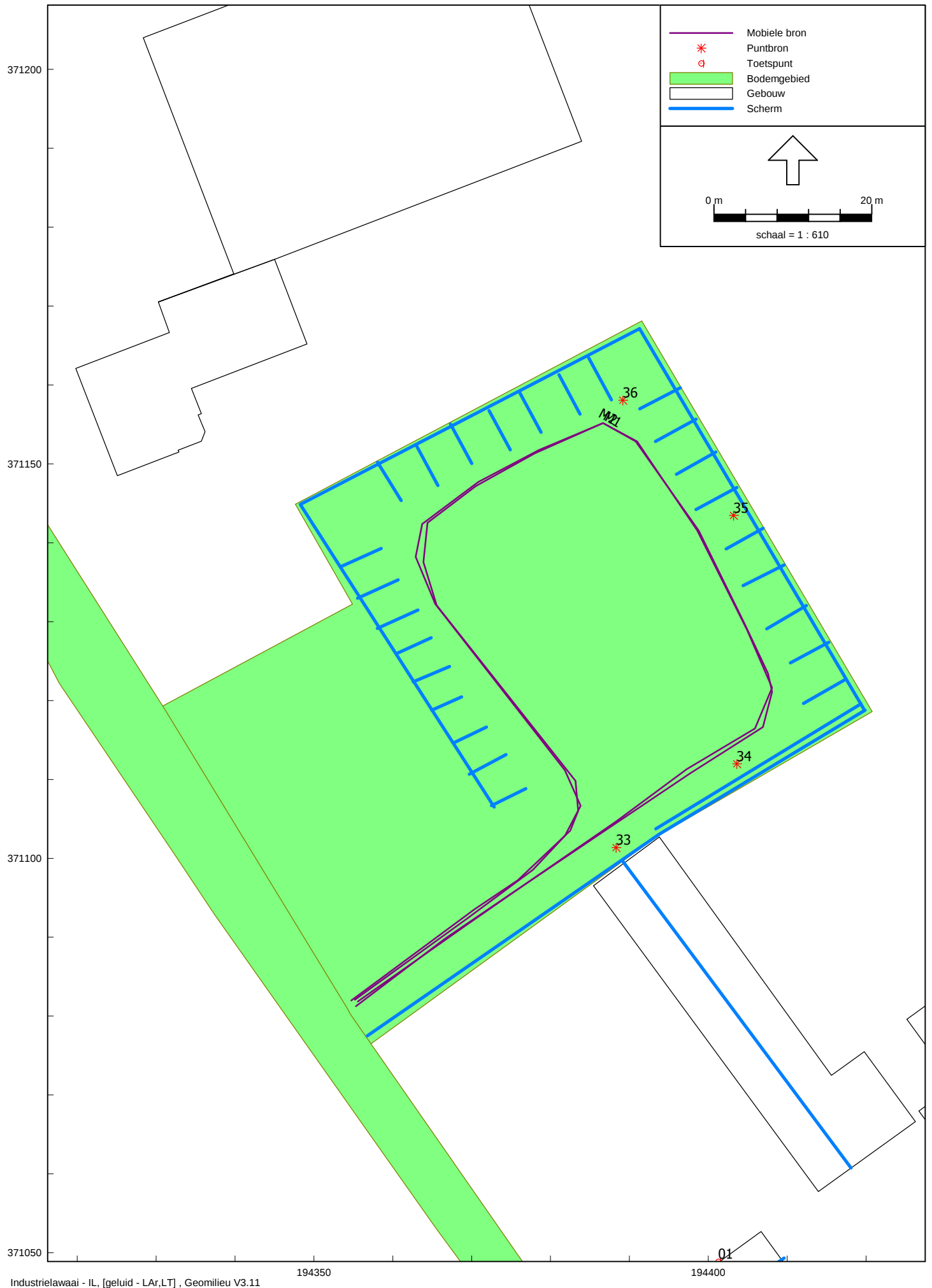
Figuur 5a: grafische weergave rekenmodel - geluidbronnen LAr,LT
