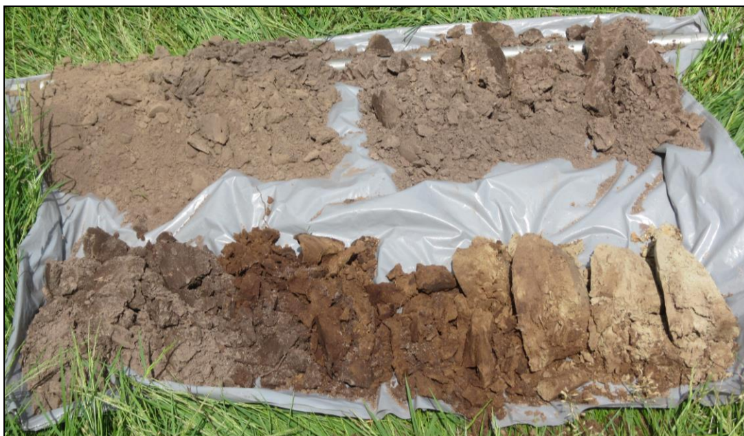
Figuur 7: Zicht op boring 2 uitgelegd van linksboven naar rechtsonder (0-160 cm –mv).
