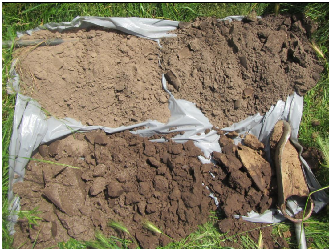
Figuur 8: Zicht op boring 7 uitgelegd van linksboven naar rechtsonder (0-180 cm –mv).
