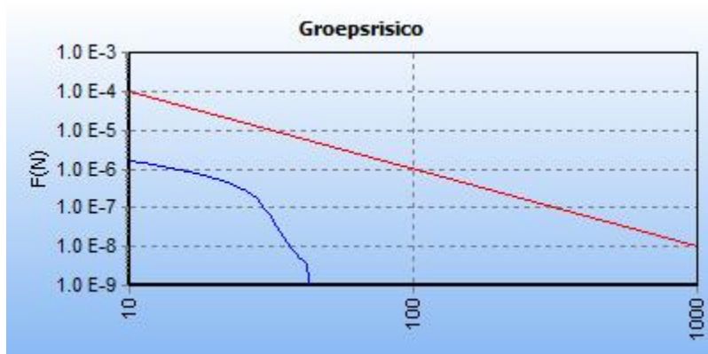
5.1 Figuur 5.10 FN curve voor 6425_leiding-Z-513-01-deel-1 van N.V. Nederlandse Gasunie voor de kilometer tussen stationing 4550.00 en stationing 5550.00
