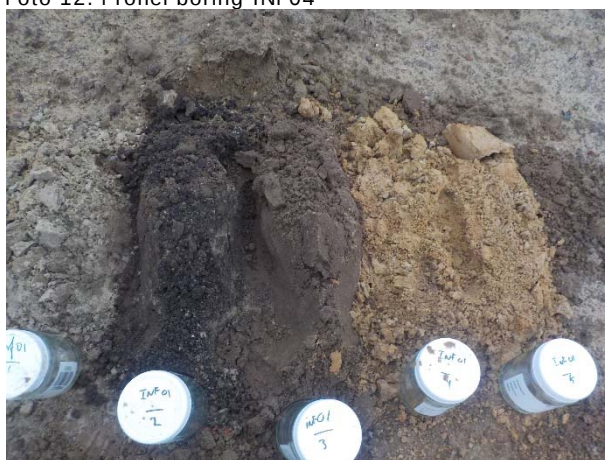
Foto 14. Profiel boring INF01
