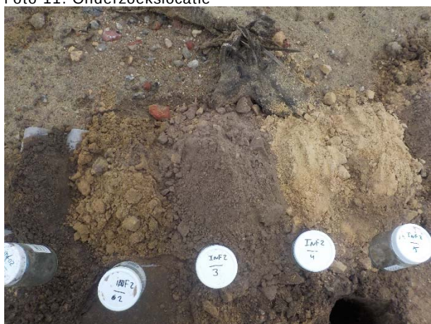
Foto 13. Profiel boring INF02
