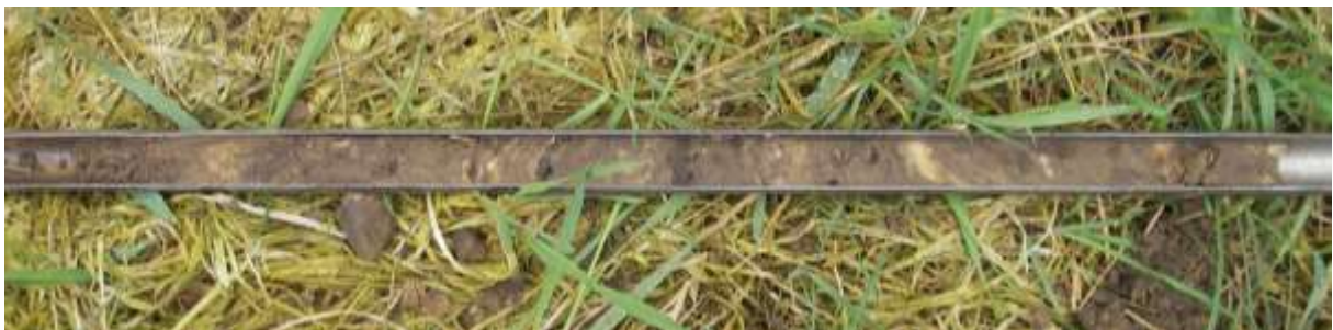
Figuur 19: Foto's van de zeer diep verstoorde bodemopbouw zoals deze in de boringen 17 en 21 tot en met 24 is aangetroffen (in dit geval in boring 21).
