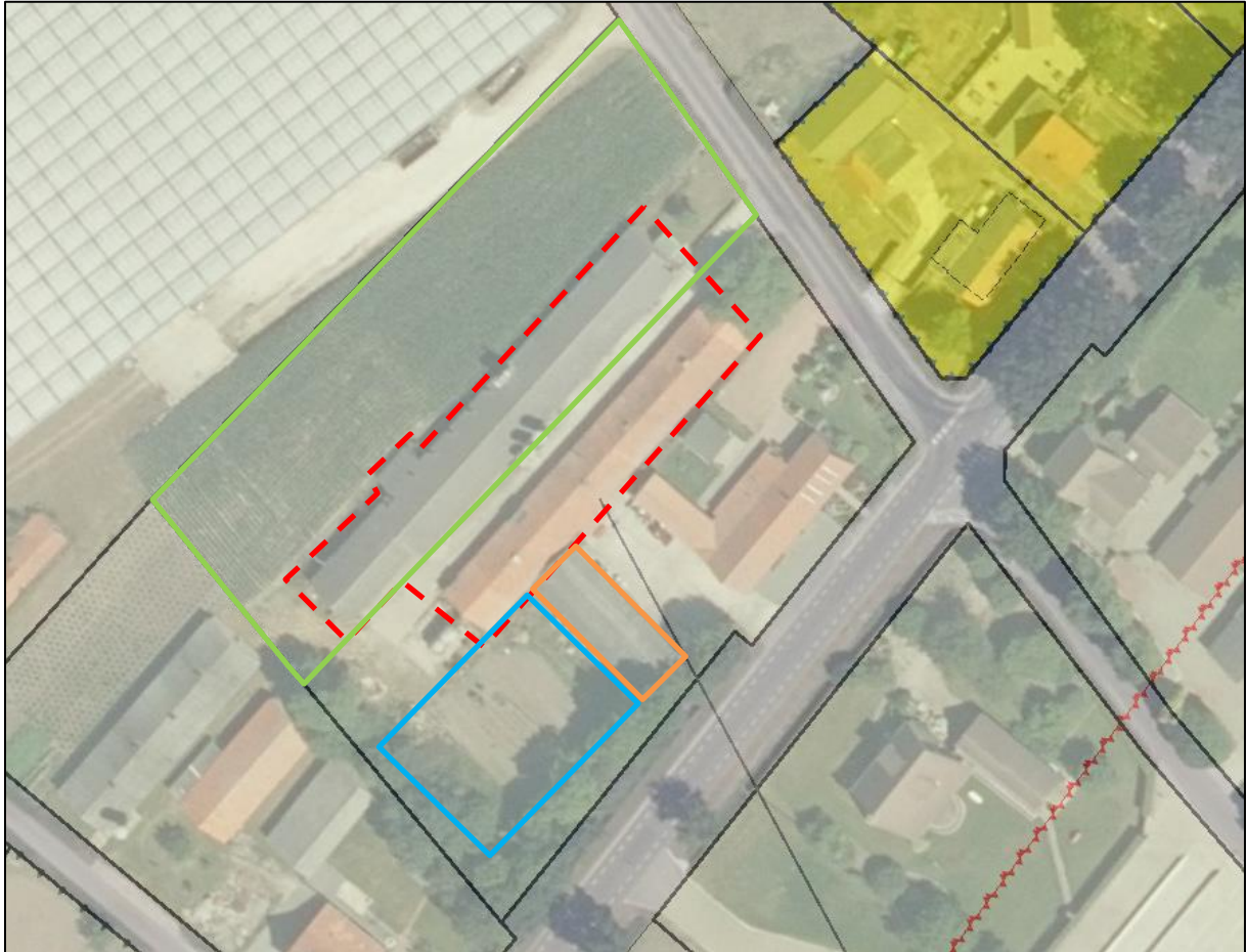
Afbeelding 6. Planvoornemen voor locatie Lorbaan 47. Rode stippellijn betreft te saneren varkensstallen, oranje omlijnd de te behouden loods, groen omlijnd het te verwijderen bouwvlak en toekomstig pot- en containerveld en blauw omlijnd de nieuw beoogde loods.
