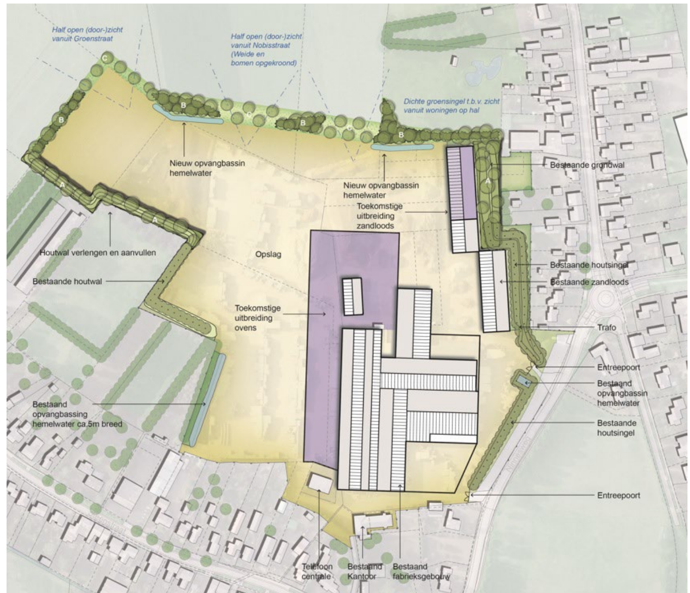
Figuur 4: Overzichtstekening landschappelijke inpassing noordzijde (groter exemplaar is bijgevoegd).
