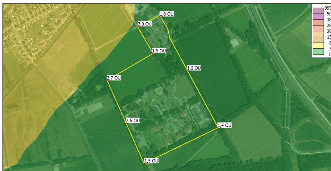
Afbeelding 4 Berekende achtergrondgeurbelasting [ \text{OU}_E/\text{m}^3 ] ter plaatse van de randen van het plangebied
