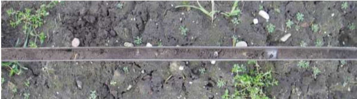
Figuur 18: Foto van het sterk verstoorde zandpakket zoals dat in alle boringen is aangetroffen.
