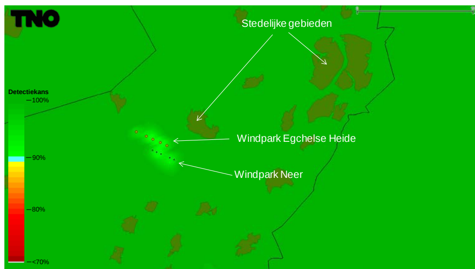
Figuur 7 Detectiekans van het MASS primaire verkeersleidingsradarnetwerk op 1000 voet boven het bouwplan nadat deze is gerealiseerd. De locaties van de windturbines zijn aangegeven met gele stippen.
