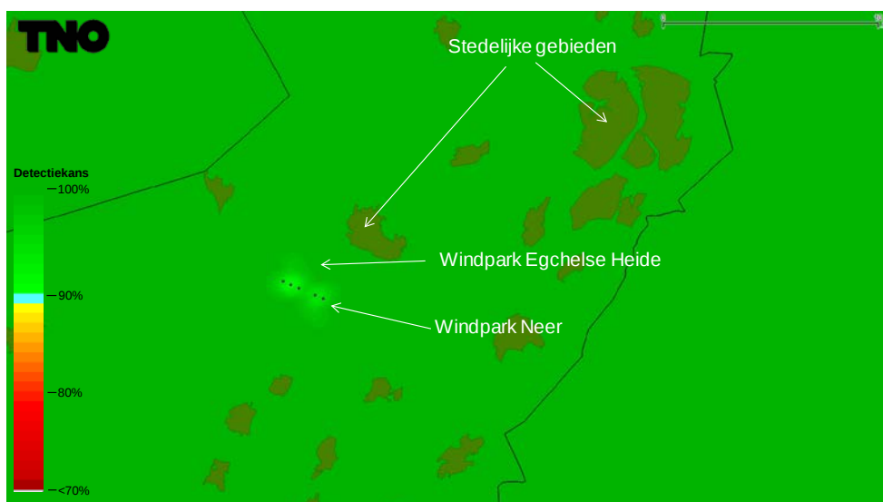
Figuur 6 Detectiekans van het MASS primaire verkeersleidingsradarnetwerk op 1000 voet boven het bouwplan voordat dit is gerealiseerd (baseline).
