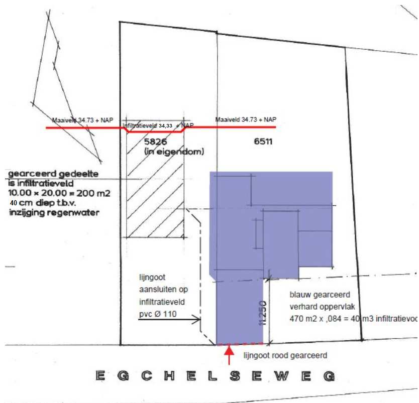
Figuur 14: Omvang, ligging en dwarsdoorsnede van de infiltratievoorziening
