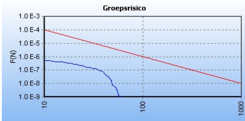
Figuur 4.1.3 FN curve voor de kilometer tussen stationing 8630.00 en stationing 9630.00
