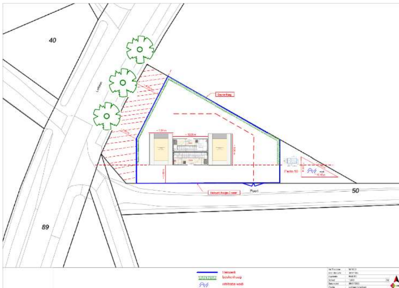
Figuur 2.1: Situering trafostations en transformatoren
