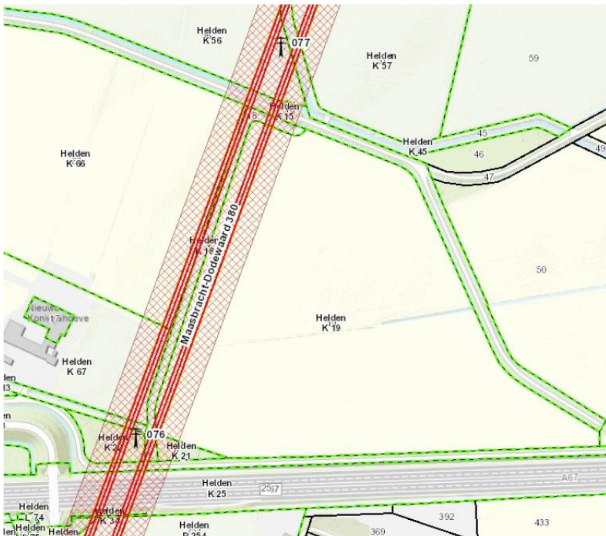
Figuur 12 Belemmeringenstrook TenneT
