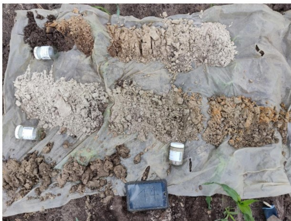
Afbeelding 11: Foto profielboring 14 uitgelegd per halve meter vanaf maaiveld (linksboven) tot einddiepte (rechtsonder).
