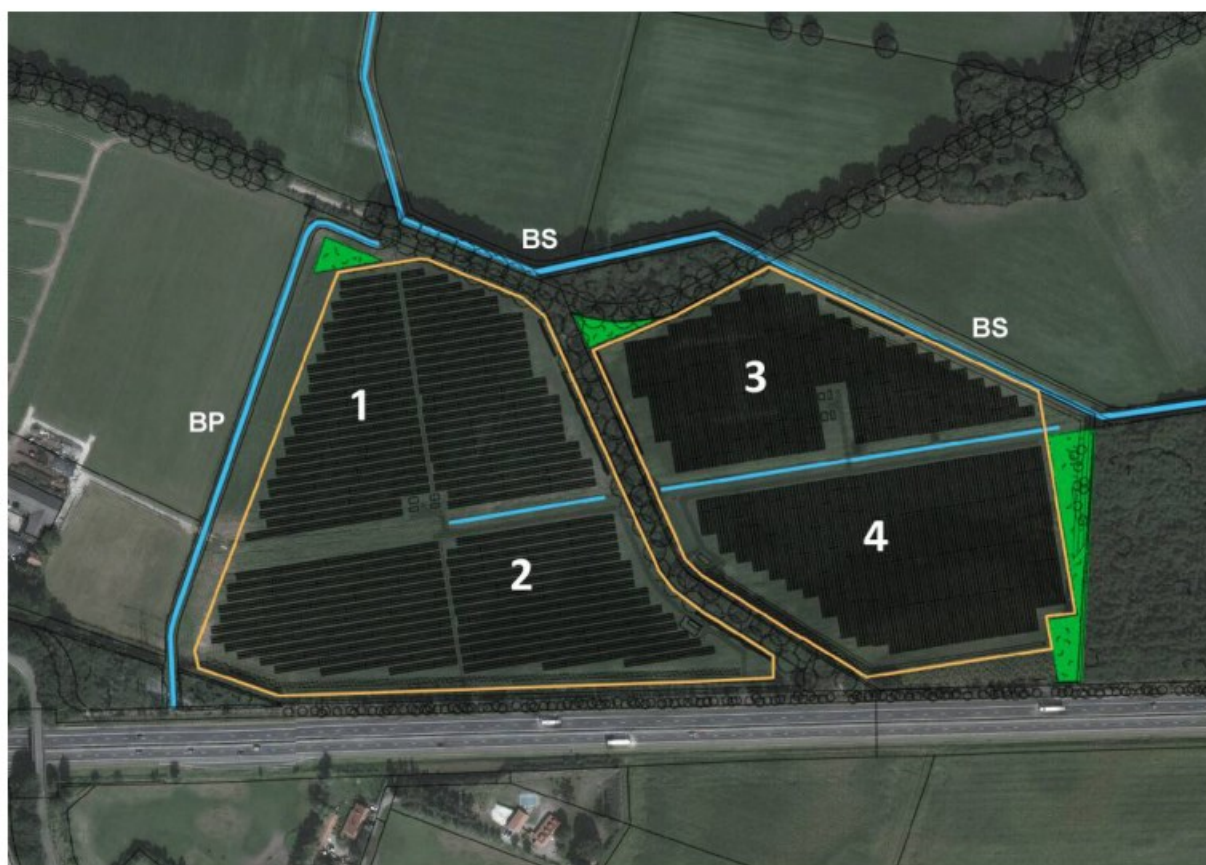
De inrichtingstekening van Zonnepark Spiesberg met de bosjes in de overhoeken (groen) en het hekwerk rondom (oranje). Die vier paneelvelden vallen binnen de groene contramal. Het oppervlaktewater in de vorm van sloten en greppels is ook aangeduid in blauw. Met aan de westzijde de Breedschen Peel (BP) en aan de noordzijde de Boksloot (BS).
