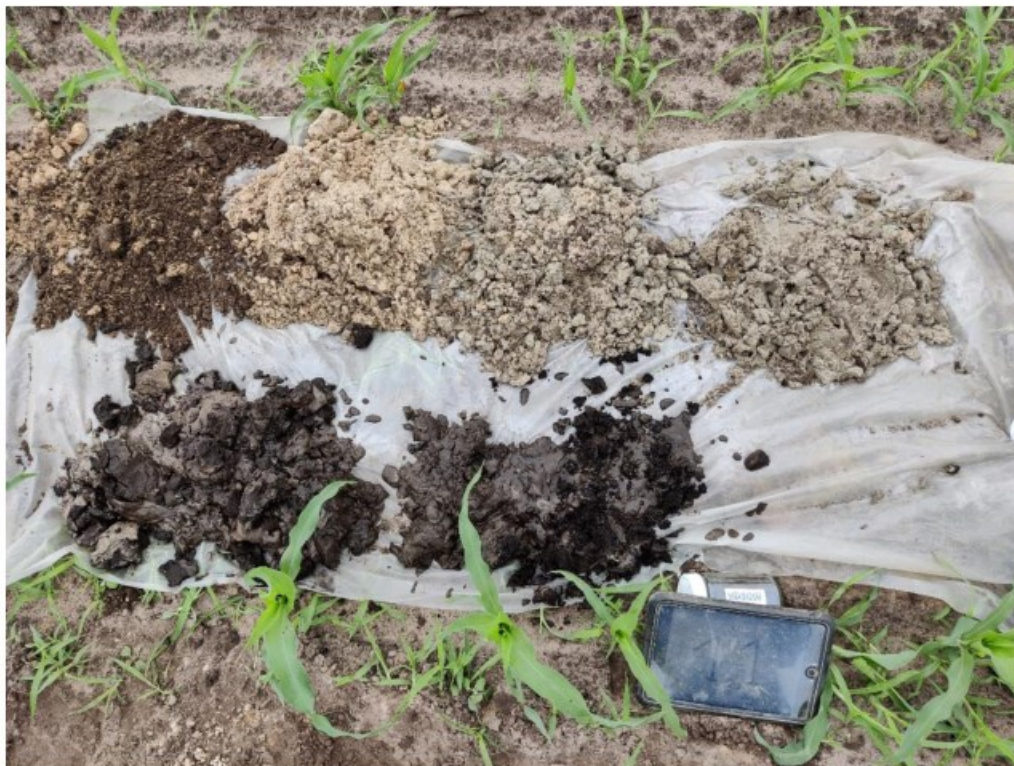
Afbeelding 12: Foto profielboring 11 uitgelegd per halve meter vanaf maaiveld (linksboven) tot einddiepte (rechtsonder).
