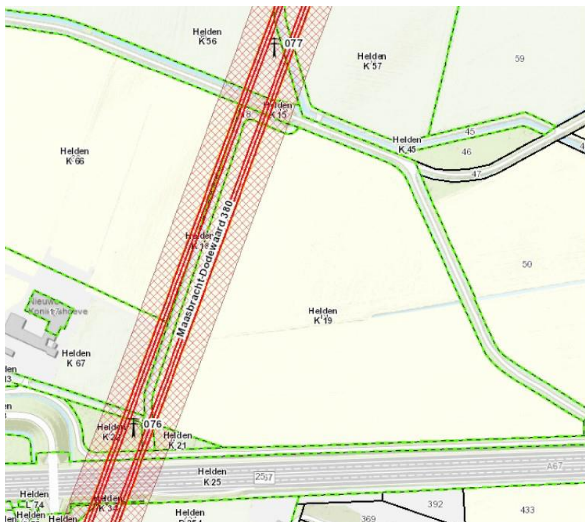
Figuur 12 Belemmeringenstrook TenneT
