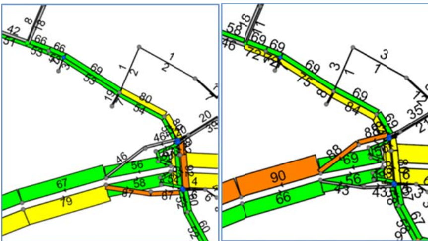
Figuur 6.2 Uitsnede I/C-waarden (%) autonome situatie 2030 Aansluiting A67/Eindhovenseweg in de ochtendspits (links) en avondspits (rechts)
