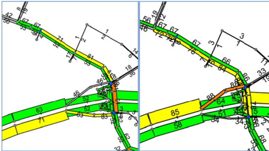
Figuur 63 Uitsnede I/C-waarden (%) basisalternatief 2022 Aansluiting A67/Eindhovenseweg in de ochtendspits (links) en avondspits (rechts)
