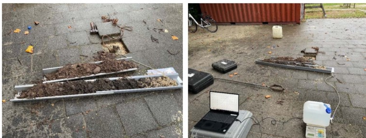
Figuur 8: Bodemprofiel infiltratieboring en meetopstelling.
